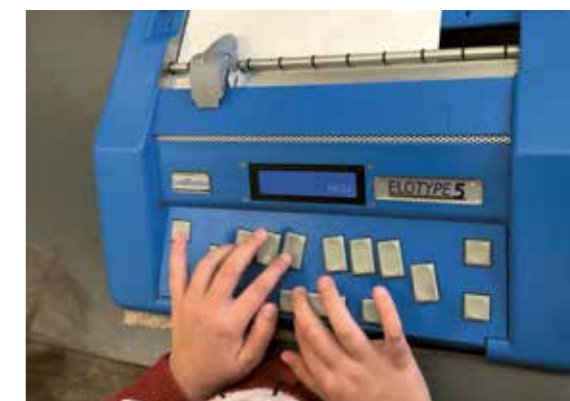
Die Elotype 5 ist eine elektronische Brailleschrift-Maschine mit ergonomischer Tastatur.
