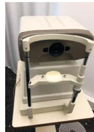
Der Autorefraktometer misst Fehrsichtigkeit mit Hilfe von infrarotem Licht.
